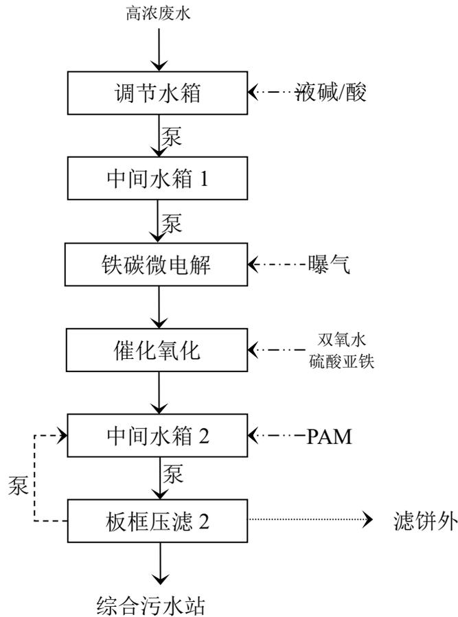
图 4.1.2-4 高浓废水预处理工艺流程
