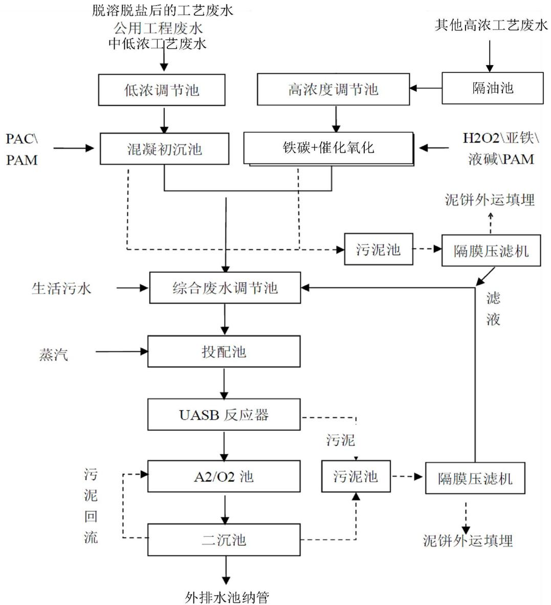
图 4.1.2-5 已提升后的废水综合处理工艺图
