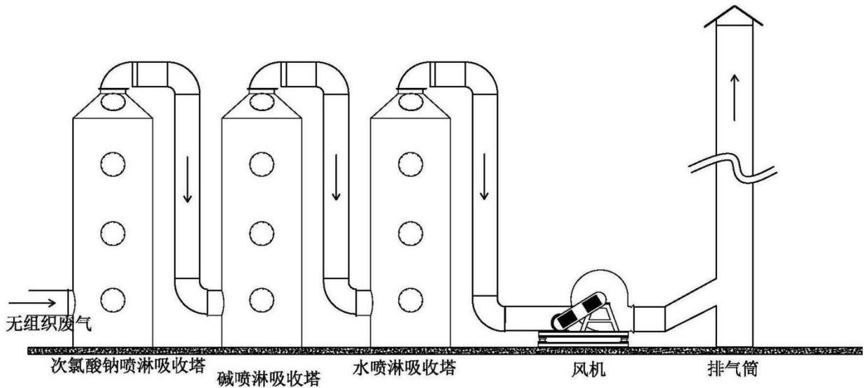
图 4.2.2-2 2# 废气喷淋装置处理处理流程
