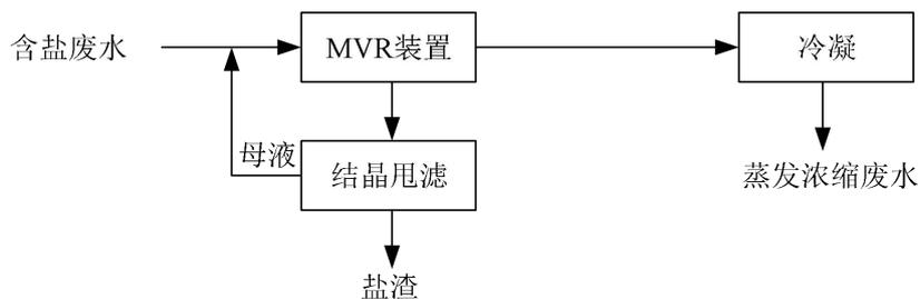
图 4.1.2-3 MVR 装置处理工艺
