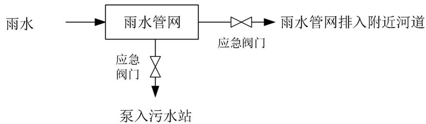
图 4.1.2-1 厂区初期雨水、事故废水收集系统示意图
